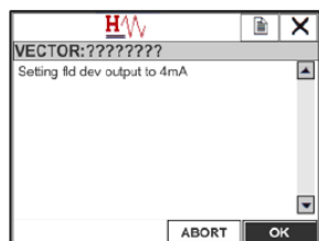
Рисунок 5-34: Настройка значения выходного сигнала 4 мА
