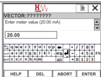
Рисунок 5-38: Ввод измеренного тока 20 мА
